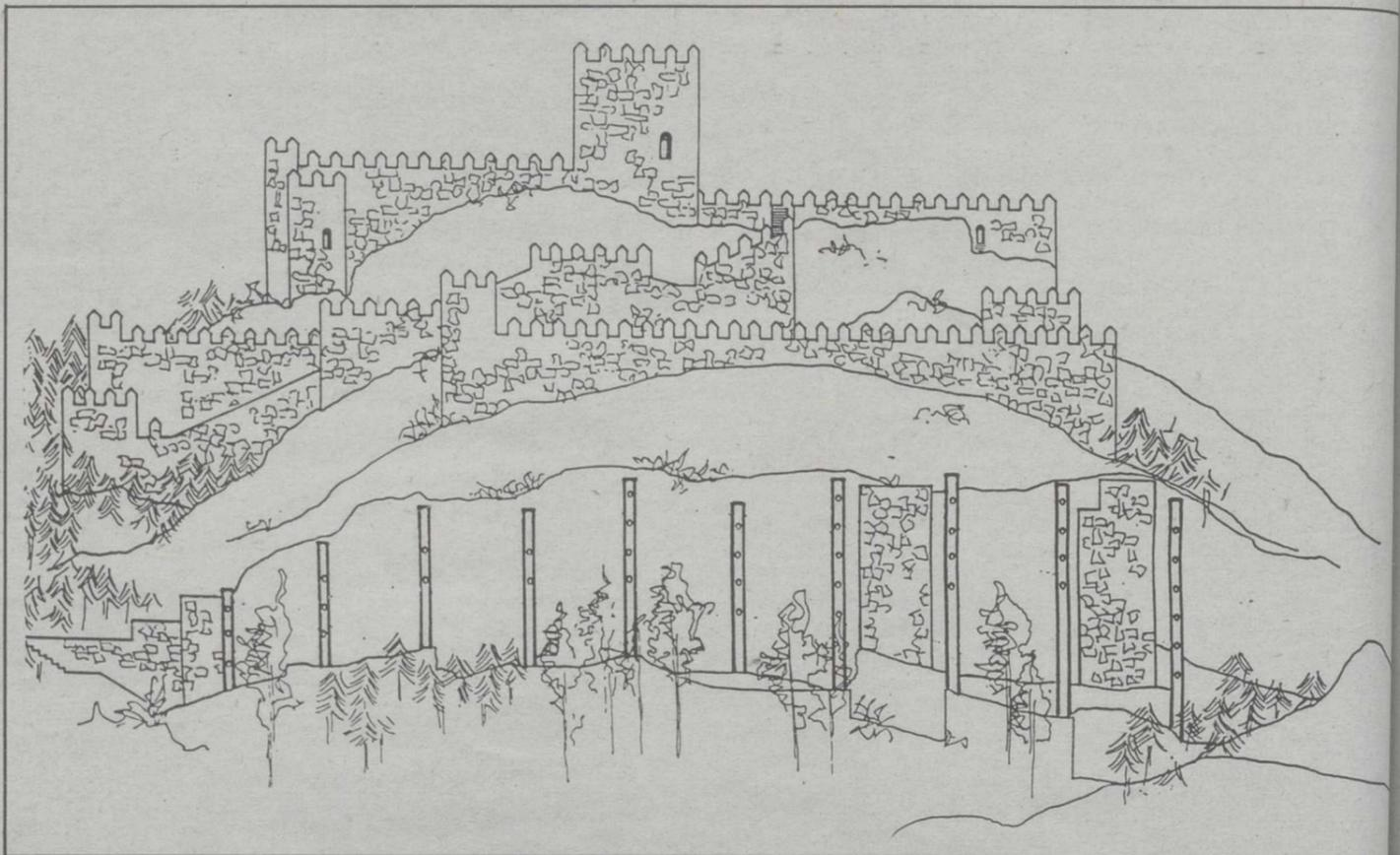
Mediante la instalación de anclajes que cosan los estratos inclinados se eliminarán las grietas y fisuras que, por otra parte, alteran la estética del castillo
