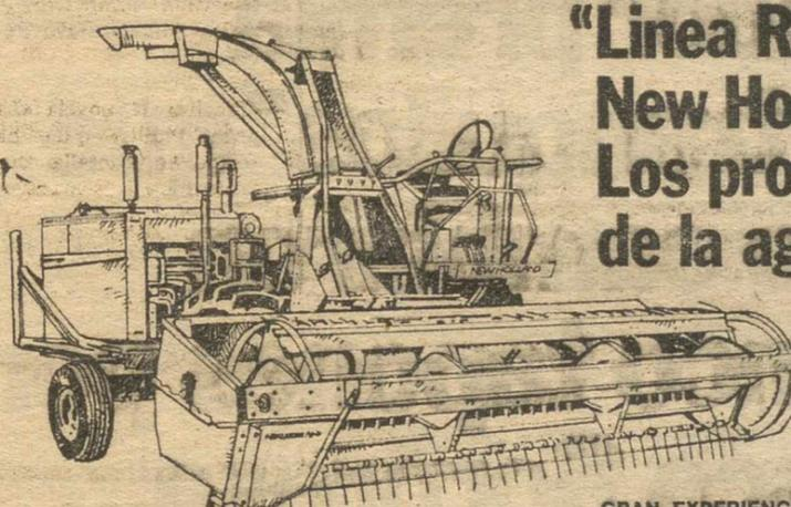
**Recogedora Picadora de corte exacto autopropulsada.**
