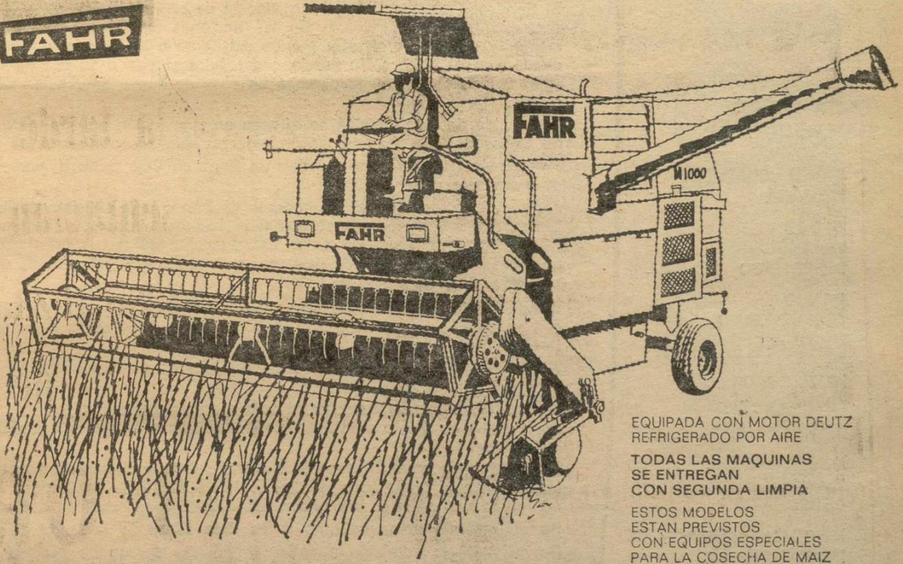
EQUIPADA CON MOTOR DEUTZ REFRIGERADO POR AIRE
