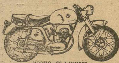
MODELO - CC 4 TIEMPOS 150 cc. P. V. P. 21.975 Ptas. Consumo - 2,5 l/100 Km. (Sin mezcla de aceite)
