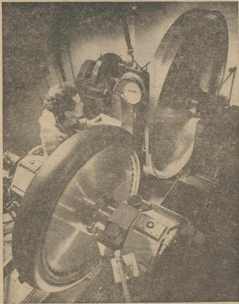
En la planta para probar neumáticos de coches de carreras, situada en Fort Dunlop (Birmingham) Inglaterra, un operario lee las indicaciones de un calibrador de carga, durante las operaciones de calibración del equipo de carga por control a distancia.
