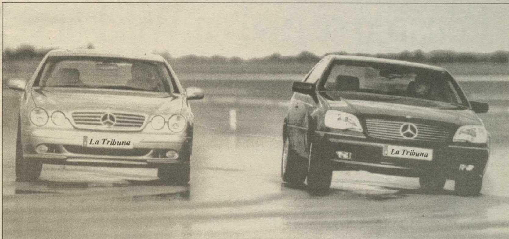
En la foto se ve la diferencia de balanceo y apoyo en dos vehículos iguales con y sin ABC.
