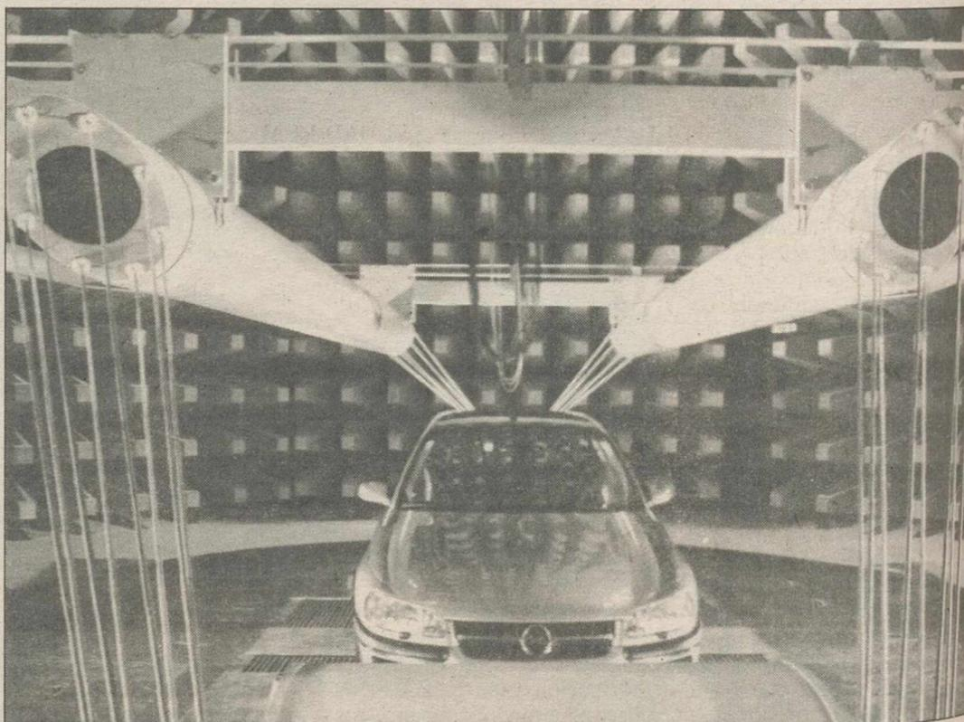
Opel analiza la inmunidad de los sistemas electrónicos de sus vehículos frente a interferencias.
