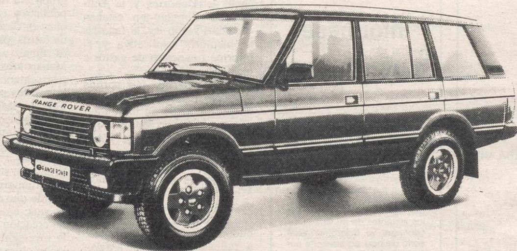
Adelántese a su tiempo con el nuevo Range Rover Vogue LSE. Por su poderoso motor V8 de 4,2 l. y 200 CV. Por el aumento del chasis en 20 cm. Por sus revolucionarios sistemas electrónicos de suspensión neu-
