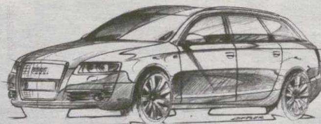
Su alta línea de cintura, la estrecha área de los cristales, la línea del techo similar al coupé, plana y curvándose ligeramente al final, le otorgan a toda la carrocería del vehículo un aspecto afilado y dinámico.
