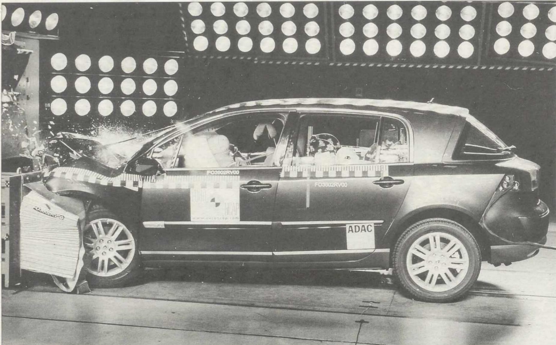
Imagen de la prueba de colisión frontal realizada al Renault Vel Satis, que obtuvo 5 estrellas en seguridad. En la foto inferior, muñecos de niños sirven para analizar cómo afectan las colisiones a éstos.
