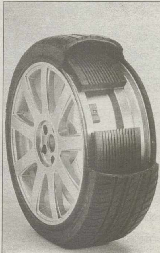
A la izquierda, una rueda con el Pax de Michelin; a la derecha, sección de llanta, neumático y Pax
