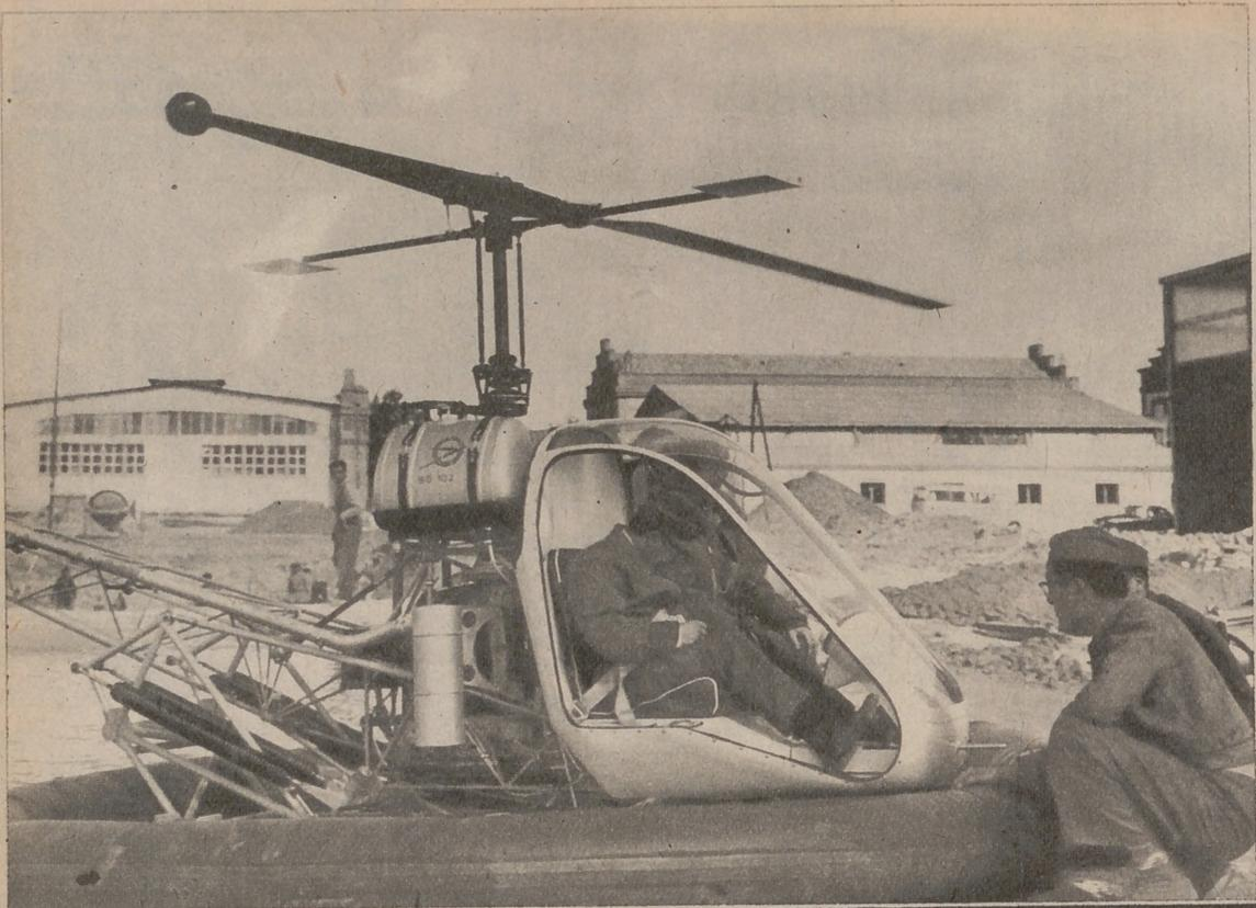
Un "helicóptero" de ensayos, emplazado sobre una balsa de goma, sirve para familiarizar a los alumnos con los movimientos en el aire
