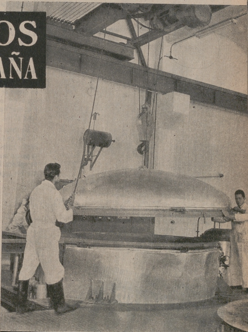
ESTE MODERNO HORNO DE SUBLIMACION, INSTALADO EN LA MONCLOA, ES PREPARADO PARA ENTRAR EN FUNCIONAMIENTO.
