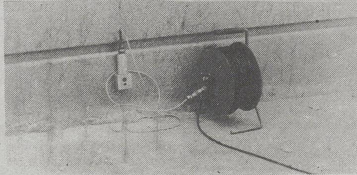
Ingenieros del Instituto Geológico realizaron medidas de vibraciones producidas por la explosión de barrenos en un solar existente en la calle de San Millán y lugares próximos a él. Ese solar será edificado y en él será necesario el empleo de barrenos debido a la piedra existente. Por esa razón se procedió a la medida de las vibraciones con el fin de evitar que, en su momento, se ocasionen daños en los muros de las edificaciones próximas.
