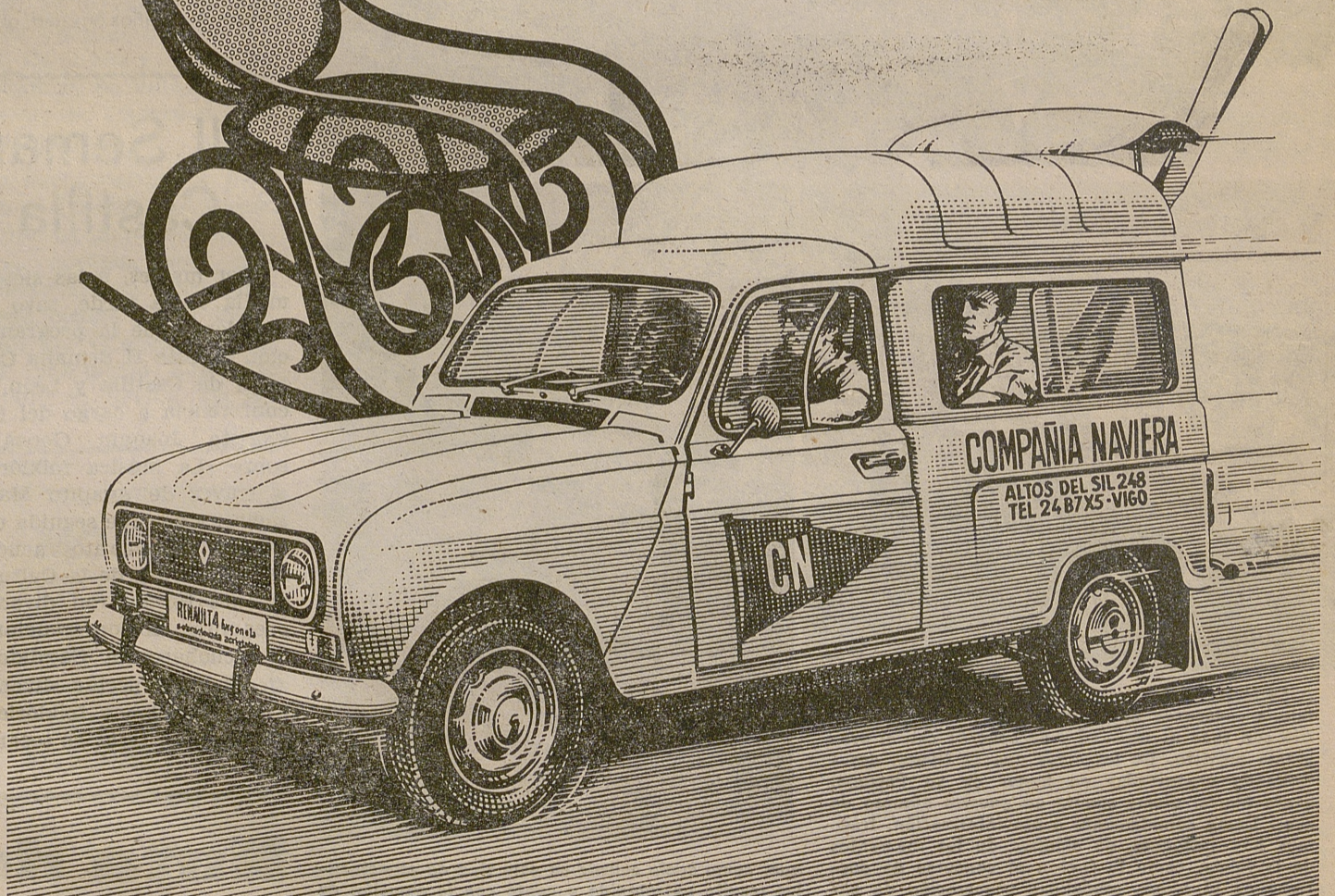
Motor Renault de 852 cm 3 , tracción delantera y piso plano
