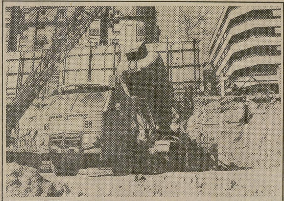
Hacen falta 200.000 m<sup>3</sup> de hormigón para construir unos edificios. Los camiones-hormigonera Pegaso 3.060 GL, de 200 cv., los llevan. La gran solidez de su bastidor, así como la de su eje delantero; el puente posterior, provisto de un sistema de bloqueo a voluntad, mediante un tercer diferencial, permiten a este Pegaso actuar en terrenos difíciles. Con suspensión especial trasera mediante tacos de goma. La servo-dirección, con mando hidráulico, posibilita una conducción más cómoda.
