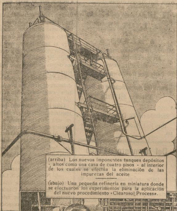
(arriba) Los nuevos imponentes tanques depósitos - altos como una casa de cuatro pisos - al interior de los cuales se efectúa la eliminación de las impurezas del aceite
