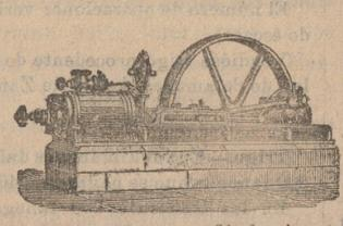
Máquina de vapor fija horizontal
