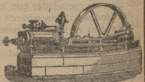
Máquina de vapor fija horizontal
