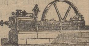
Máquina de vapor fija horizontal
