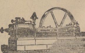
Máquina de vapor fija horizontal
