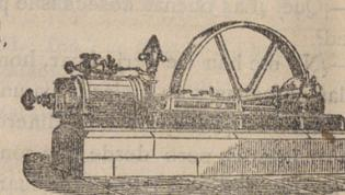
Máquina de vapor fija horizontal
