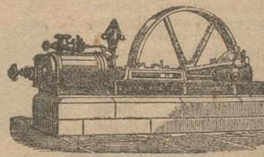
Máquina de vapor fija horizontal
