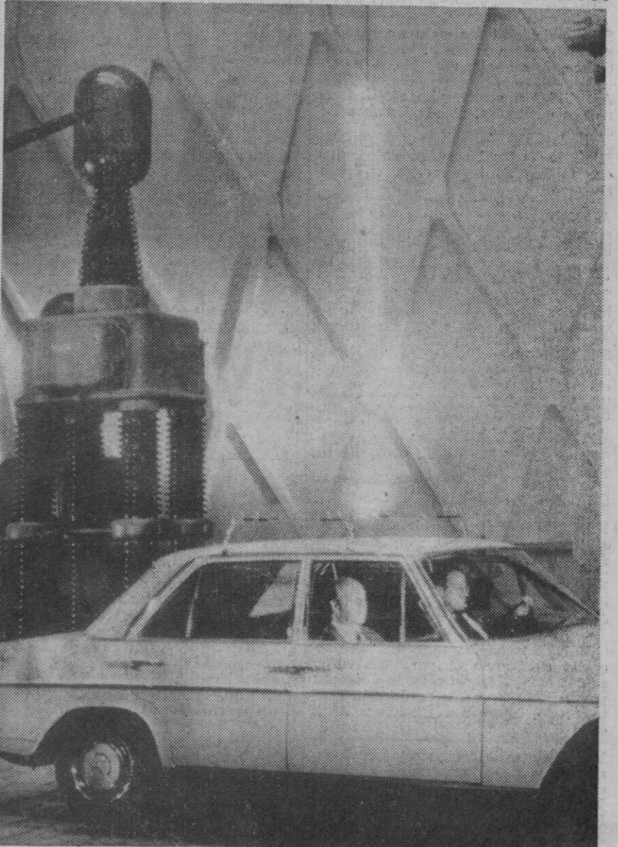
Infundado es el miedo de muchos automovilistas a tormentas, pues la energía de un rayo es conducida por la pared exterior del vehículo al suelo. Para demostrarlo, científicos de la Siemens en Berlín Occidental condujeron la energía de la potencia de un rayo (2 millones de voltios) a un coche cerrado. Quedaron incólumes tanto los pasajeros como el automóvil. Sin embargo, se aconseja que, al desencadenarse una tormenta durante el viaje, se lleve el coche al borde de la carretera para evitar que por el susto causado por la eventual caída de un rayo el conductor reaccione erróneamente.—(DaD)
