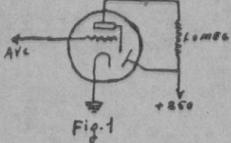
Con respecto a la fig. 1, se muestra aquí como el retorno de placa pasa a través de una resistencia de 1 meg. y va a la fuente de voltaje aplicada al electrodo. Los cambios en la corriente que pasa a través de esta resistencia de 1 meg. producen variaciones con respecto al otro electrodo.
