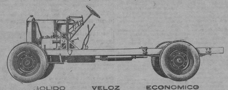
Cigüeñal montado sobre 7 soportes, grupo cilindros al níquel, cromo, frenos independientes, embrague a 4 discos conducidos. Potencia del motor al freno 42 HP. Largo del bastidor, 4,64 m. Espacio para la carrocería, 3,38 m.; gomas sencillas posteriores, 32 × 6. Ruedas de disco. Completamente equipado con guardabarros anterior y posterior, estribos, faldilla, porta-ruedas. Antes de decidir la compra del camión que necesite, pídanos catálogo y precio
