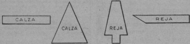
RECORTES Y PLETINAS PARA FABRICACIÓN DE HERRADURAS
