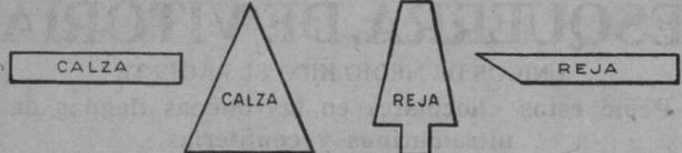
RECORTES Y PLETINAS PARA FABRICACIÓN DE HERRADURAS
