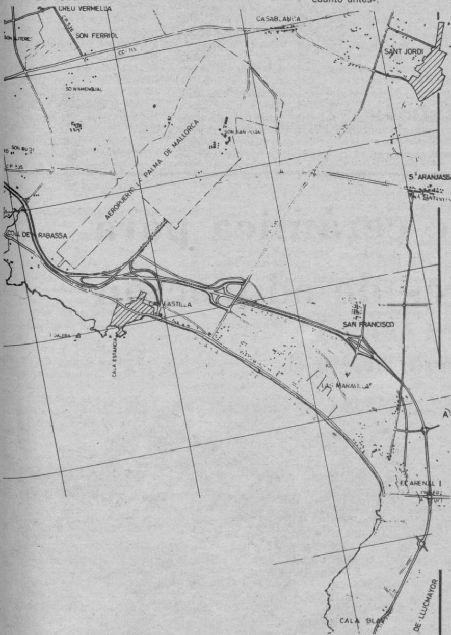
Plano en el que se señala la prolongación de la autopista del aeropuerto, convertida en autovía desde Es Pitlarí hasta la unión con la carretera de Cala Blava. En el plano se pueden apreciar las dos intersecciones y los tres cruces proyectados. No se indican los siete puentes previstos.
