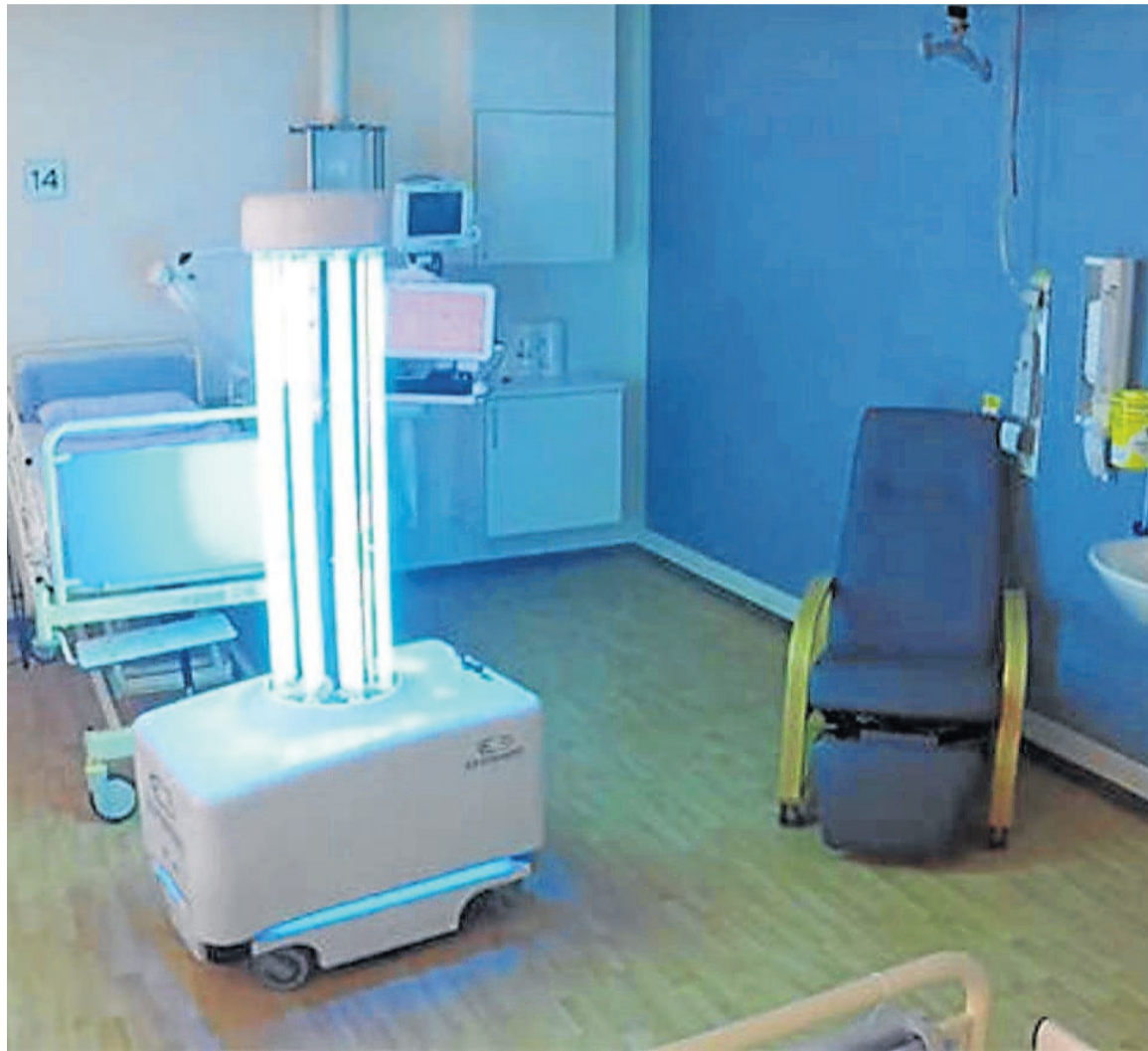
Uno de los robots de luz ultravioleta para desinfectar dependencias hospitalarias frente al Covid-19.
