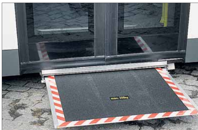
El sistema de doble rampa, una de las novedades de los vehículos. / KAMARERO
