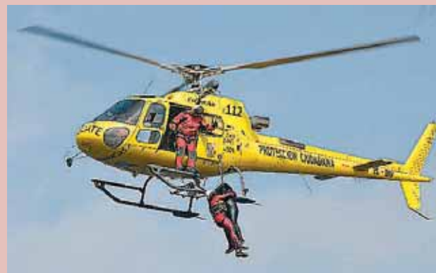
RESCATE. Desde el helicóptero, un operador de grúa descuelga a un rescatador hasta la víctima, a la que se coloca un cincho. Finalmente, el operador eleva a la víctima y al rescatador.
