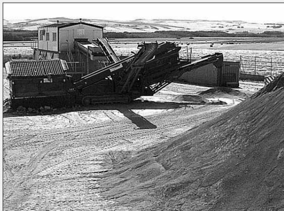
Mediante procesos mecánicos se van separando los diferentes materiales (maderas, metales...). Los ladrillos usados y los hormigones pasan por una machacadora, resultando finalmente diferentes tipos de zorra.
