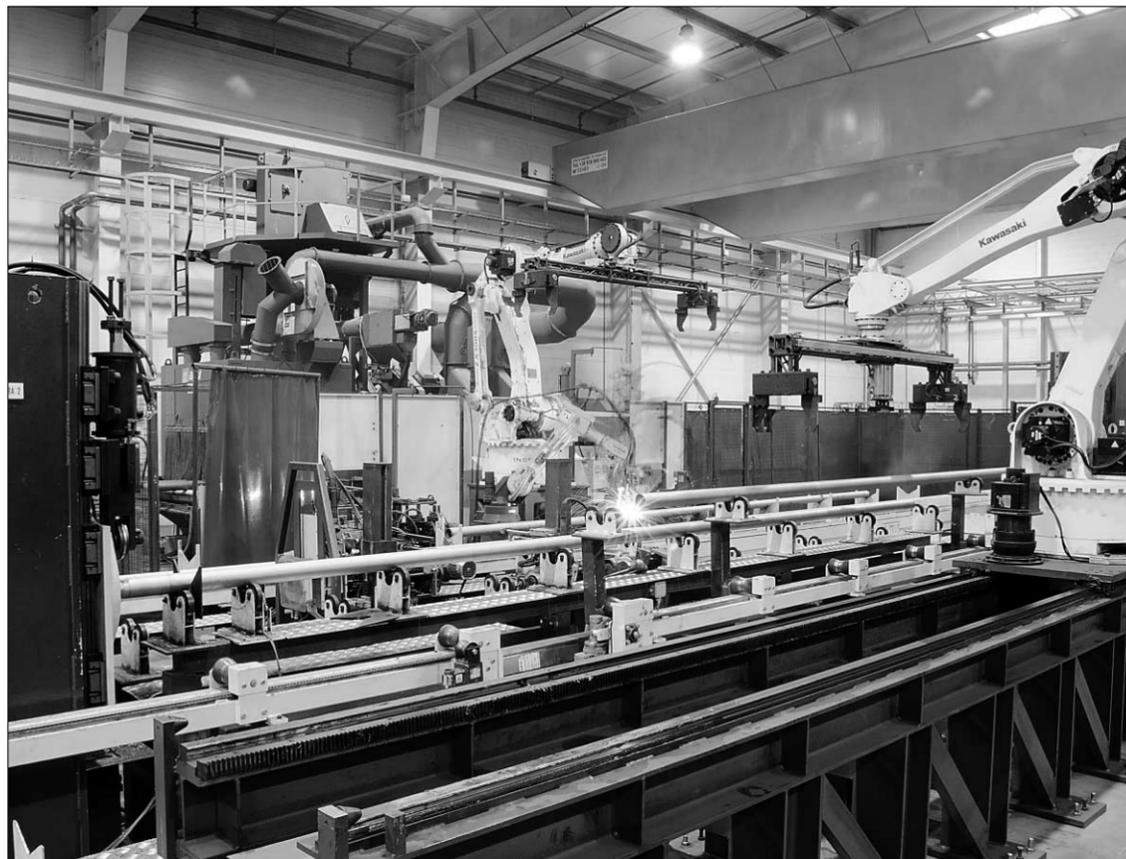
La célula robotizada de soldadura, el corazón de Prefabricados Técnicos de Tuberías, PTT.
