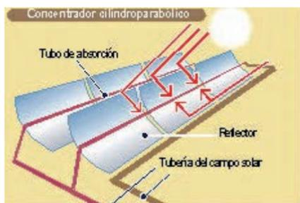
Calentado a unos 360°C por los rayos solares concentrados, se bombea este aceite en una serie de intercambiadores de calor para producir vapor sobrecalentado. Este vapor se convierte en energía eléctrica en un generador de turbina de gas convencional, que puede ser parte de un ciclo de vapor convencional o integrado en un sistema de ciclo combinado de vapor y gas.
