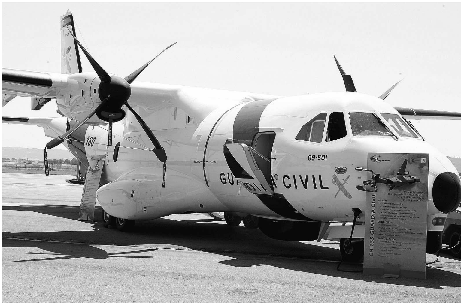
El nuevo aparato tiene una autonomía de 4.700 kilómetros y puede mantenerse en el aire durante más de 10 horas consecutivas. / EFE
