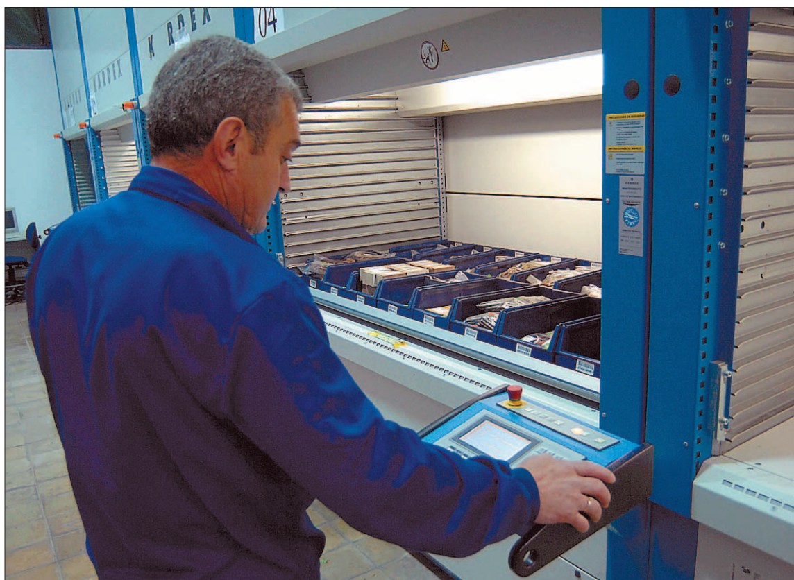
El sistema "Kardex" de almacenaje permite optimizar recursos y localizar las piezas de repuesto eficazmente./JUAN MARTÍN
