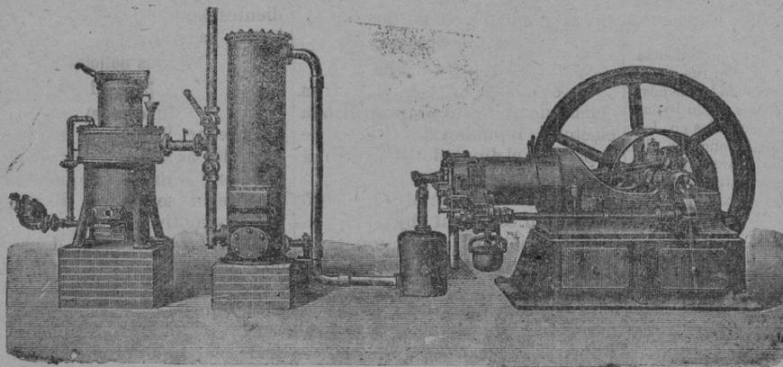
Motores de gas combinados con fábrica de GAS POBRE del nuevo sistema por aspiración.
