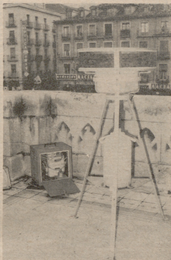
Aparatos de control de contaminación atmosférica. A la izquierda, el aparato de medida de anhídrido sulfuroso y humos. A la derecha, un medidor de polvos (partículas sedimentables). Ambos instrumentos se encuentran situados en un balcón del Ayuntamiento.
