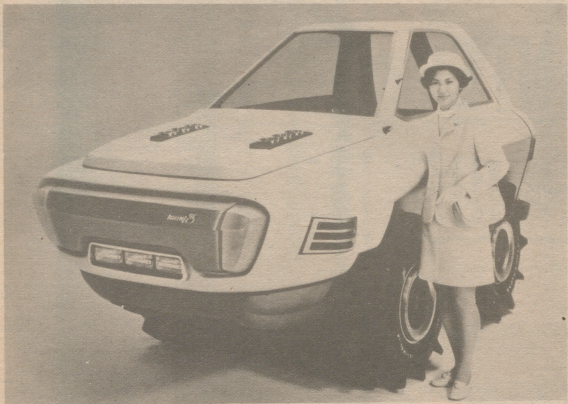
OSAKA (Japón).— Aunque no lo parezca, a juzgar por sus líneas, el vehículo de la foto será el tractor agrícola del futuro. Acaba de ser presentado en la Exposición Internacional "Osaka 70", por la empresa Kuvota. Tiene motor de 25 caballos, transmisión automática a las cuatro ruedas y neumáticos especiales "todo terreno" y puede funcionar por control remoto, siendo "captado" su trabajo a través de cámaras de televisión.
