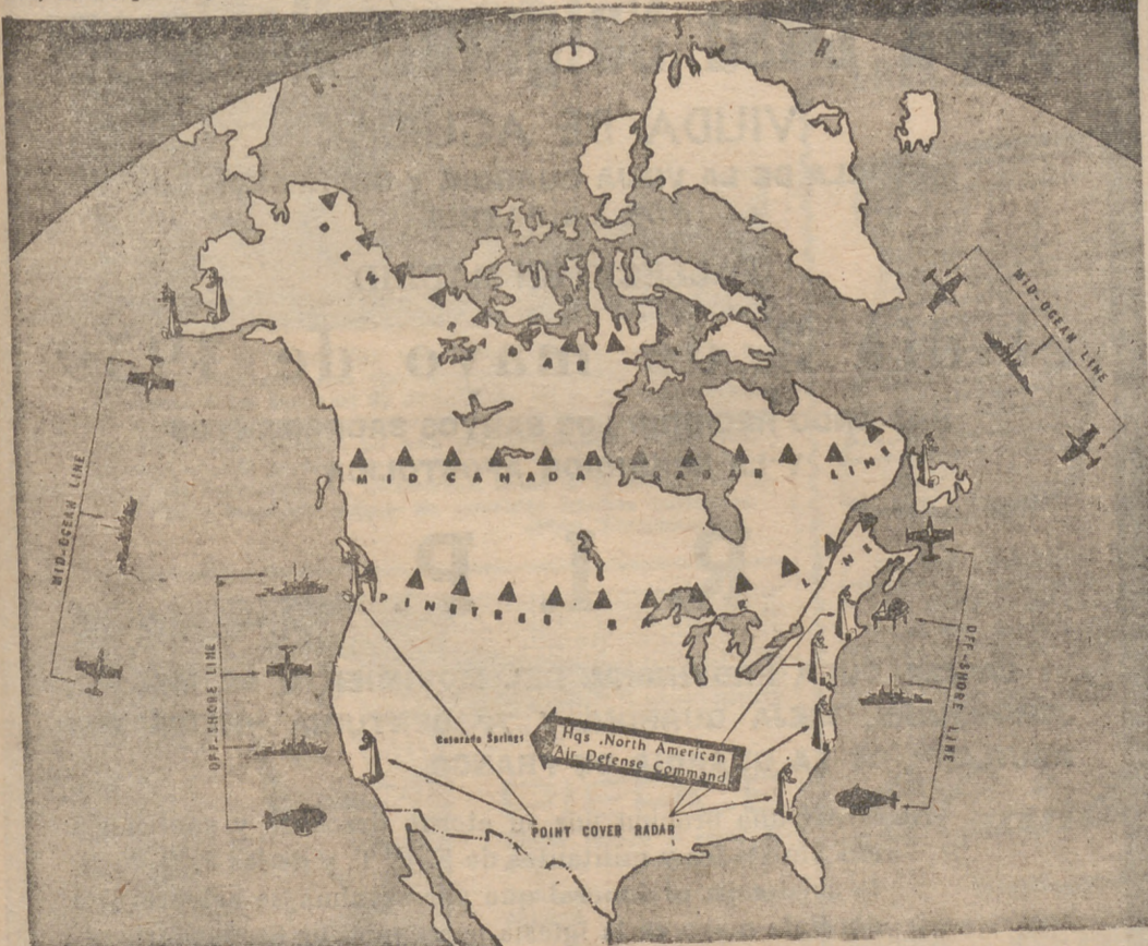
Líneas de radar que protegen el continente. Las señaladas con unos triángulos son las tres terrestres; las marítimas están montadas a bordo de buques, aviones y globos, y las costeras cubren la periferia atlántica y pacífica.
