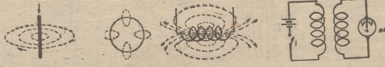
Fig. 4.—Campo de un conductor rectilíneo, de una espira y de un bobinado.
