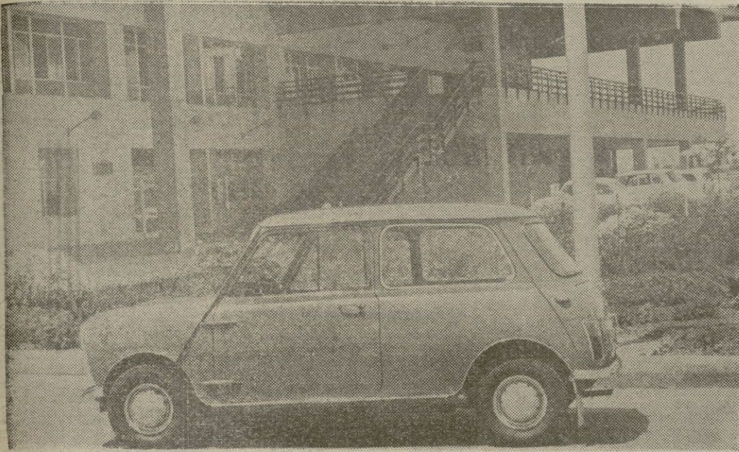
EL ÚLTIMO MODELO DE «MINI», EL 1.000, EN LA VERSION STANDARD. ALCANZA UNA VELOCIDAD DE 125 KILOMETROS A LA HORA, CON UN CONSUMO DE UNOS 8 LITROS A LOS 100 KILOMETROS Y SALE AL PRECIO (AL CONTADO) DE 137.502 PESETAS, INCLUIDOS LA MATRICULACION Y EL SEGURO POR UN AÑO.
