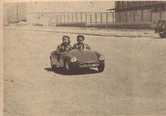
Sólo que tiene una longitud de 2,30 metros y una anchura de 96 centímetros. Su altura es de 66 centímetros. Y su peso de 100 kilos. Posee un depósito con capacidad de 6 litros. El consumo es de 1 a 1,5 litros por 100 kilómetros. Su velocidad máxima alcanzable de 28 kilómetros por hora. Frenos a tambor. Motor de dos tiempos de 49 centímetros cúbicos.
