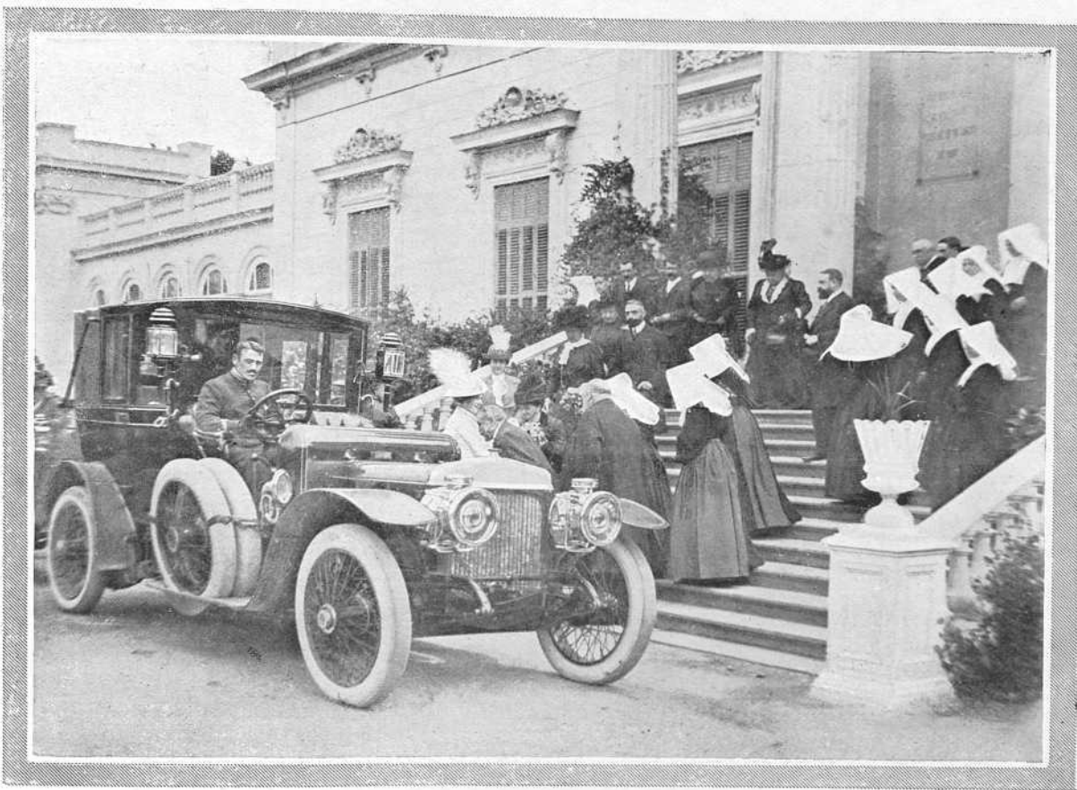
Coche Daimler, 57 H P, 6 cilindros. Fue el primer tipo, sin válvula que construyó la Casa Daimler.
