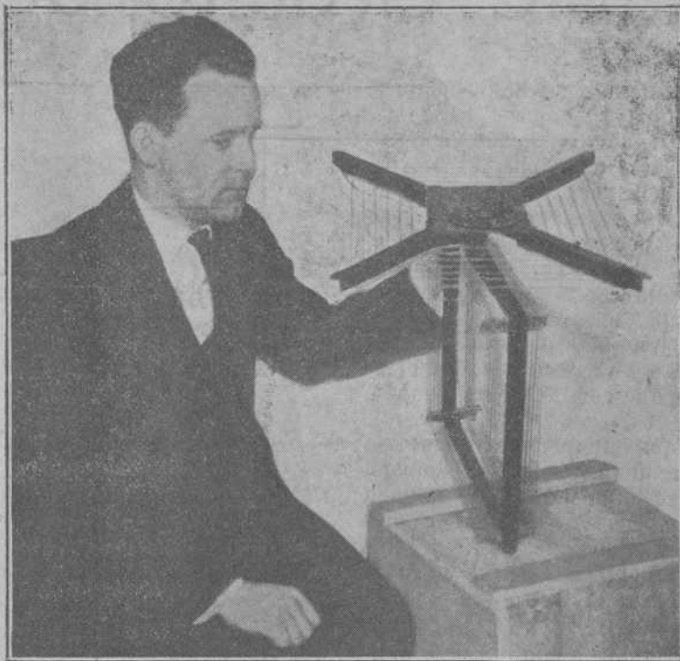
Antena de cuadro universal, popularísima entre los aficionados norteamericanos. el cuadro en si constituye un variómetro, siendo muy selectiva, y empleándose con ventaja para la recepción de onda corta.
