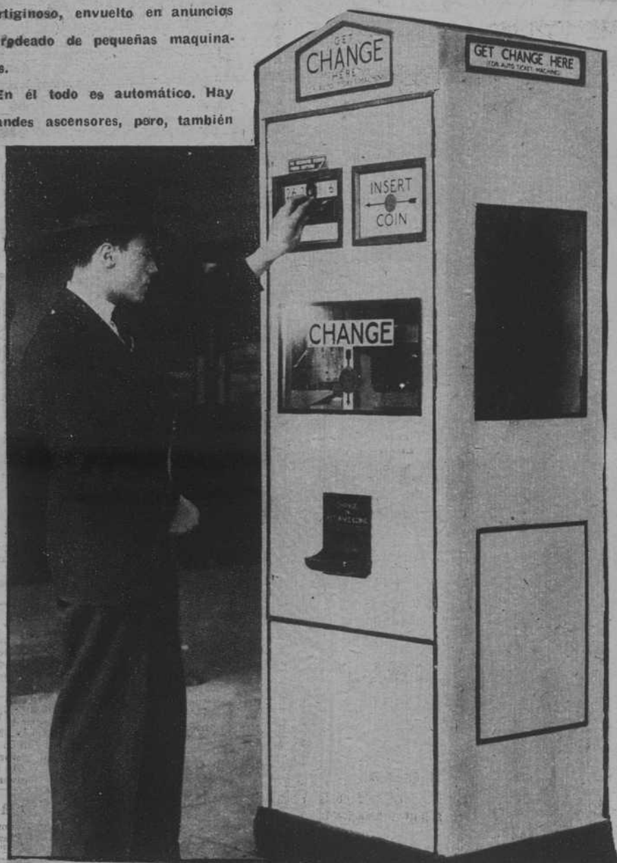
Un aparato proporciona la «calderilla» a cambio de monedas de plata, para facilitar la obtención de los billetes
