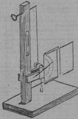
otra extremidad del cabello que pende se coloca un pedacito de plomo o de otro cualquier objeto más pesado y el higrómetro está dispuesto para funcionar.
