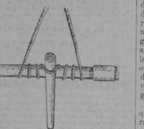
cañería como se ve en el dibujo, y en el centro se introduce el extremo de una barra fuerte que hace las veces de palanca. Sujetando bien los extremos de la cuerda y haciendo presión sobre la palanca, se destornilla en seguida la cañería sin sufrir ningún deterioro.
