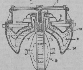
en su fondo, aislada del resto, y que llena de mercurio establece una de las comunicaciones eléctricas del motor trifásico que impulsa al volante. Otra comunicación se efectúa por un tubo que rodea al estilo y que, aislado de él, establece contacto con el mercurio de otra copilla concéntrica y aislada de la anterior y del resto de la rosa. La tercera línea de la trifásica se establece por el metal del aparato.
