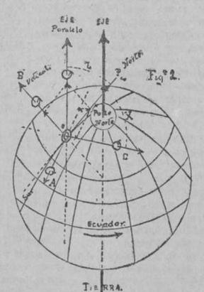
Descomponiendo la rotación sobre el eje paralelo al de la Tierra, en la figura 2, que en el hemisferio norte es positiva, según los tres ejes: vertical OB, horizontal y eje del giroscopio OC, y otro en ángulo recto con ambos OA, tendremos: que las componentes sobre OB y OC serán positivas, mientras que la sobre OA será negativa.
